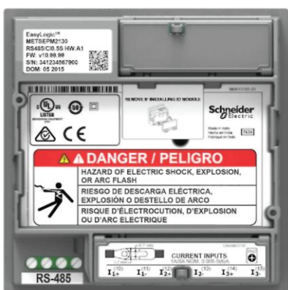
Вид PM2000 сзади без модуля ввода/вывода
